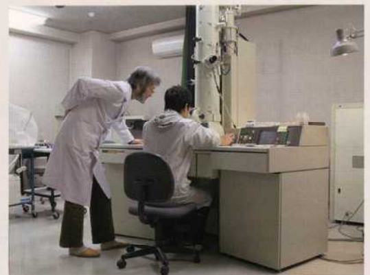
透過電子顕微鏡 (日本電子JEM-1200EX) を用いた菌の超微細構造の観察。
